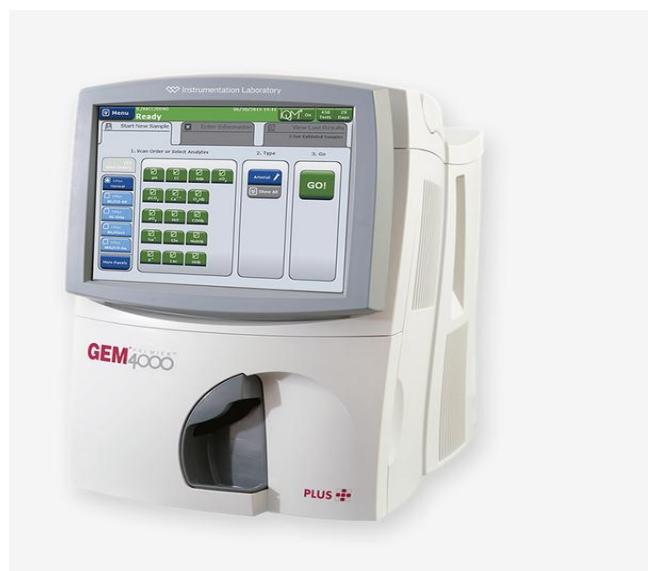
图10： 沃芬的床旁血气分析仪
