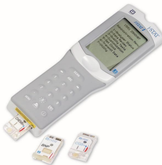
图11： 雅培的手持式血气分析仪
