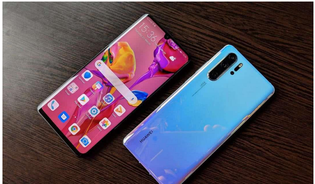
图表 35: P30 系列采用 OLED+3D 曲面玻璃
