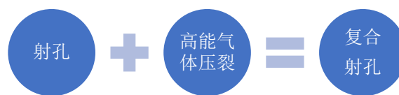
图表 20: 复合射孔集射孔和高能气体压裂于一体
