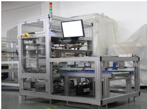
图 5：电压/内阻检测设备用于检测静置前后电芯的电压和内阻
