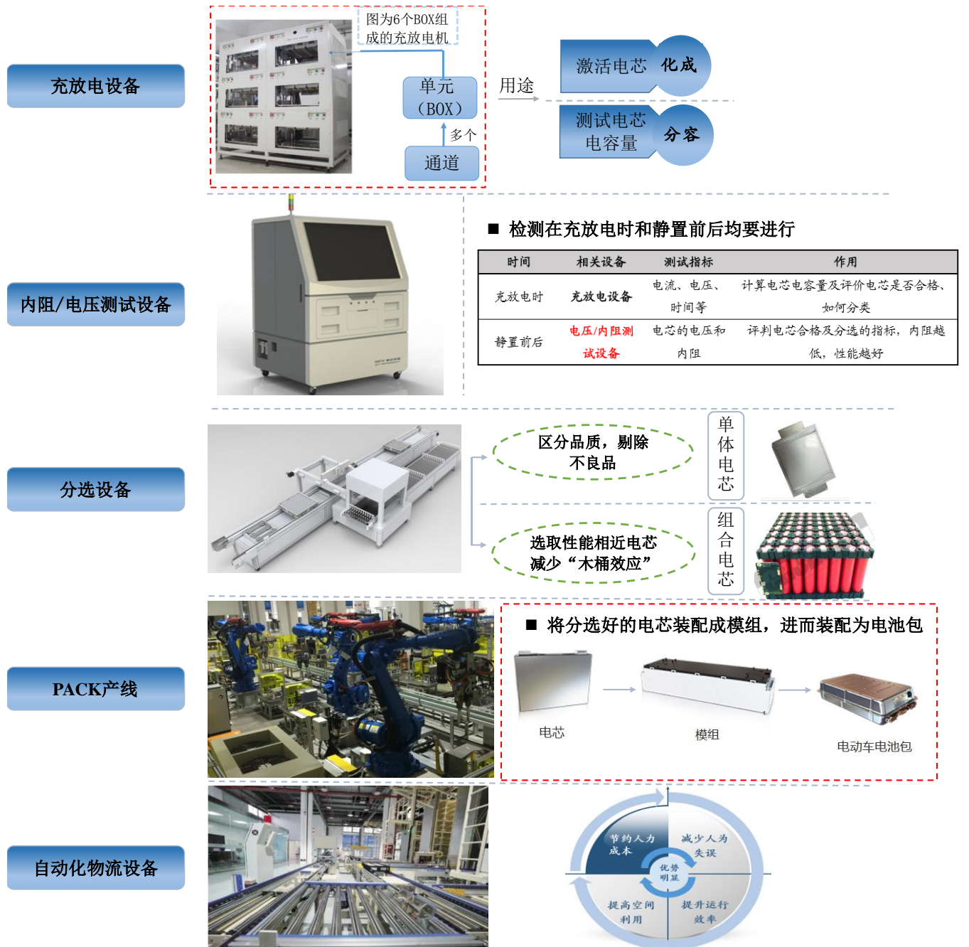
图 4：充放电设备为后处理的核心，测试分选 PACK 设备为必须，具备自动化物流现有优势
