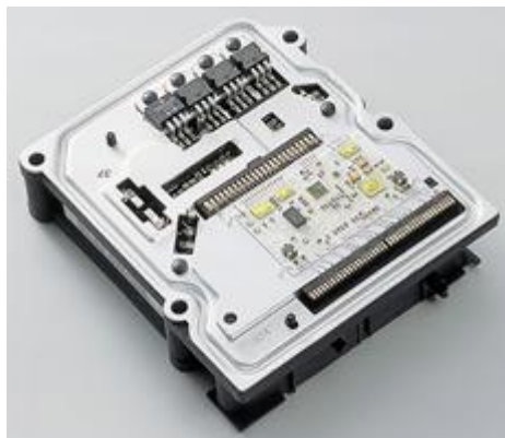
图表7: 博世 LTCC 汽车 ABS 和 ESC 控制模块示意图
