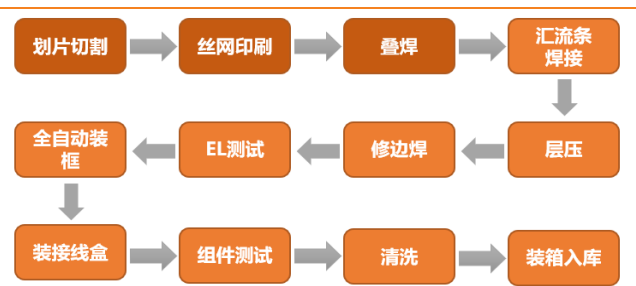
图 40：叠瓦光伏组件生产工艺
