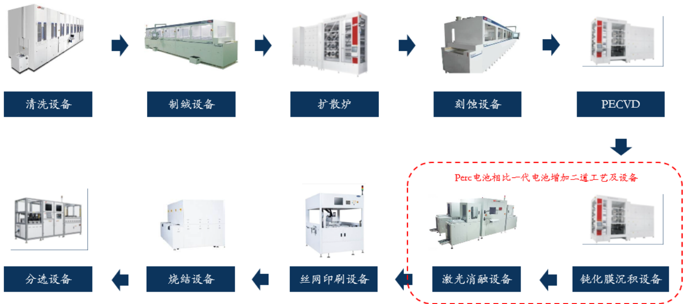
图表 44 二代电池在一代电池基础上增添背面钝化膜沉积与激光开槽工艺及相关设备
