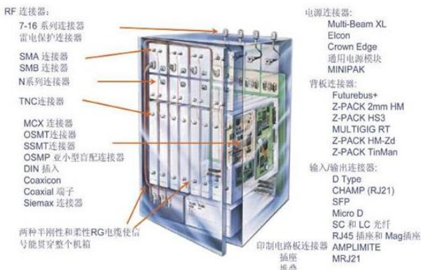
图 19:典型的无线通信系统的基站内部互联
