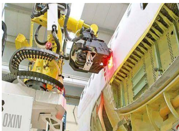
图 9:空客公司德国汉堡总装线智能钻孔机器人
