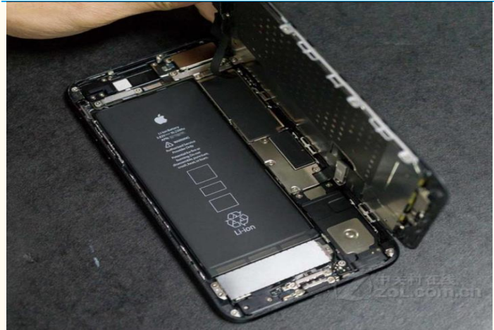
图表 30: iPhone 7 单电芯 2900mAh 体积较大
