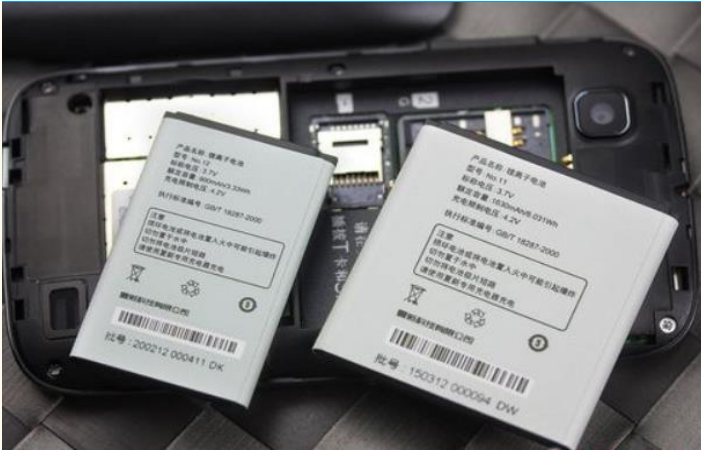
图表 28: 夏新 N809 双电芯 2530mAh (2012 年)
