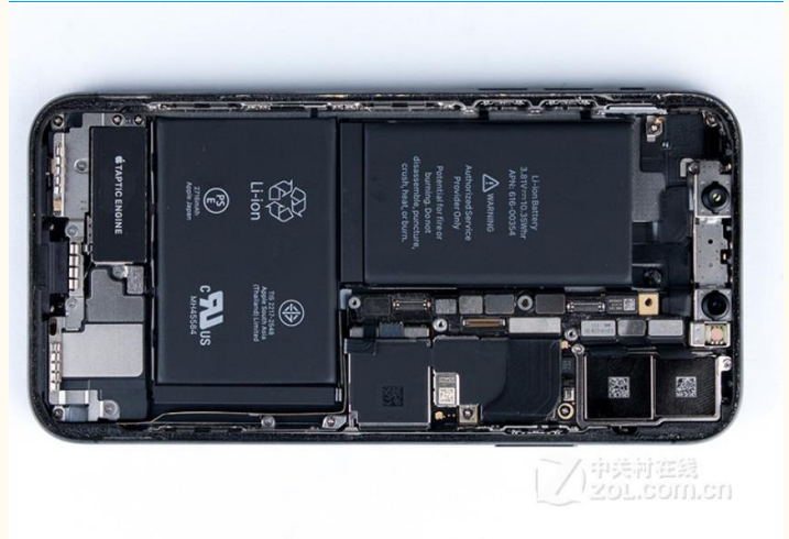
图表 31: iPhone X 双电芯 2716mAh 体积显著减小
