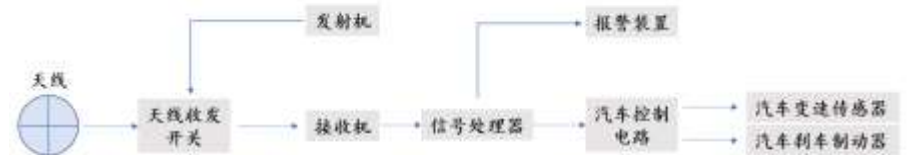
图 31: 毫米波雷达工作原理
