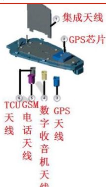
图表53: 鲨鱼鳍天线内部结构图
