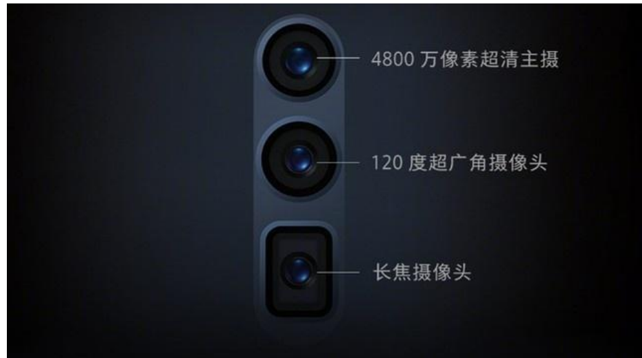
图表 60: OPPO 10 倍无损变焦技术的三摄设计
