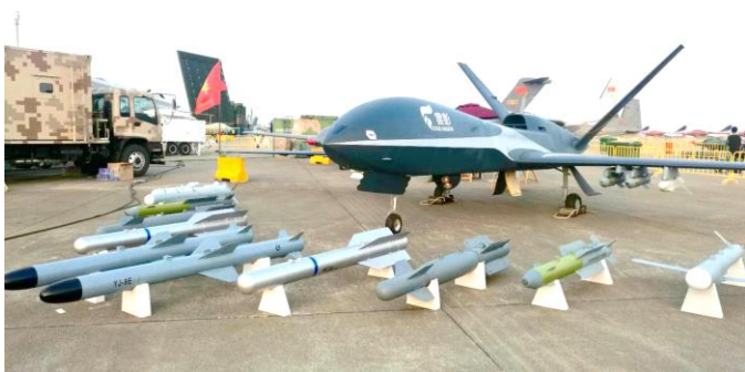
图表 39: “云影”无人机可在 14000 米巡航, 实现查打一体
