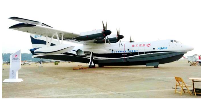
图表 40: “蛟龙-600”水陆两栖飞机, 将执行大型灭火及水上救援任务
