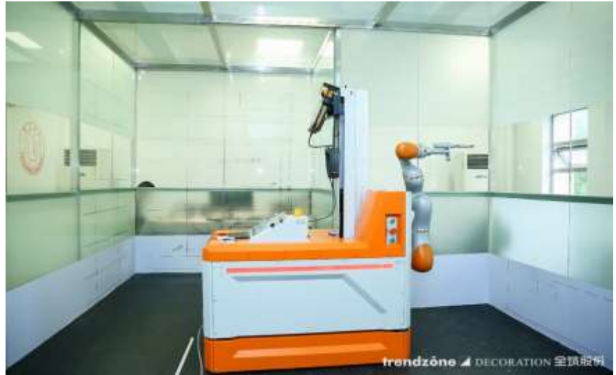
图 14: 公司研发的智能划线机器人样机
