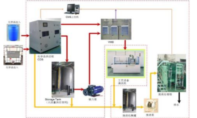
图 11: 高纯工艺系统 (化学品类)
