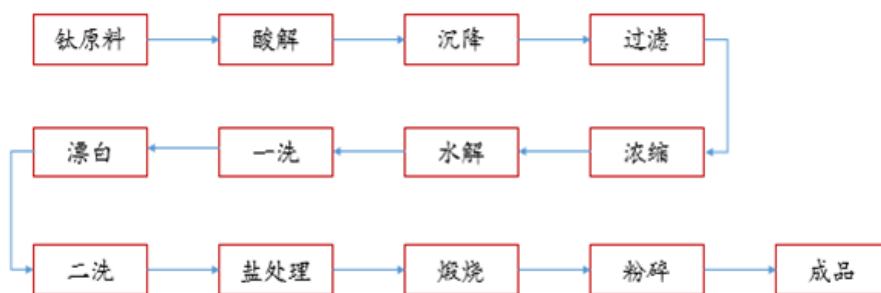
图 27：硫酸法钛白粉工艺流程
