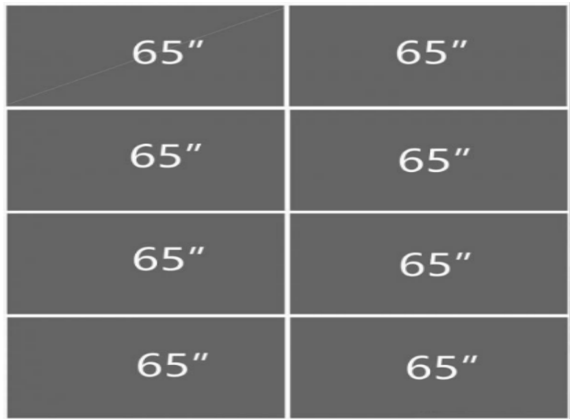
图17: 10.5 代线可以切割 8 块 65 英寸面板
