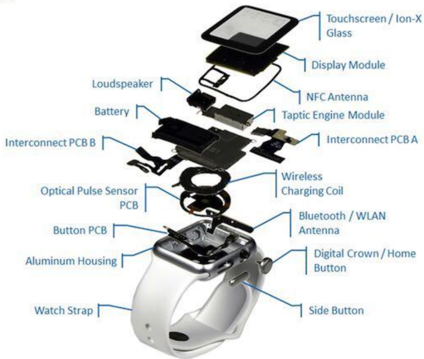
图 70: Apple Watch 内部结构
