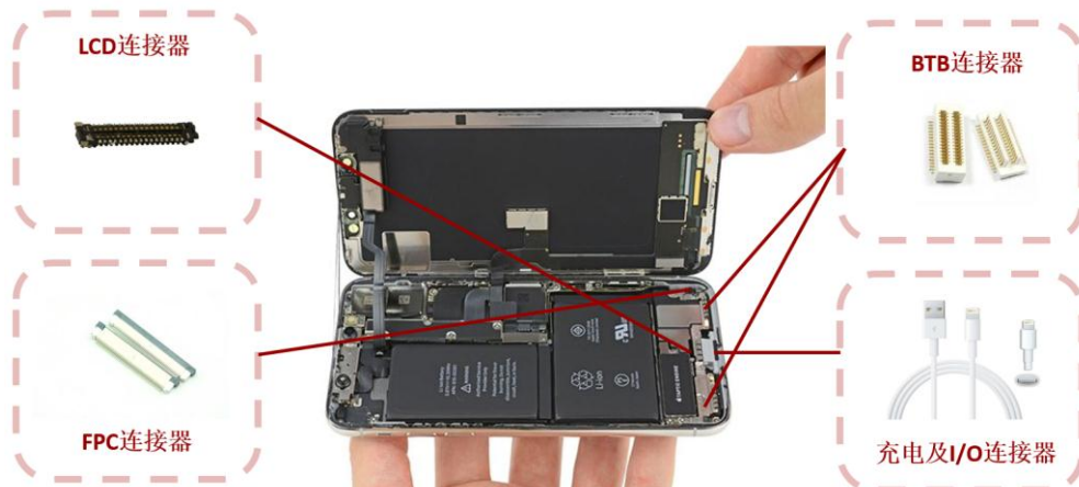
图 17: 手机内主要连接器示意图
