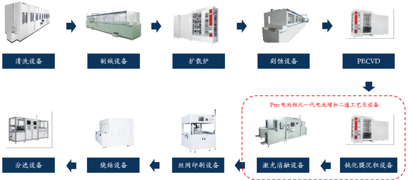
图表 5 二代电池在一代电池基础上增添背面钝化膜沉积与激光开槽工艺及相关设备
