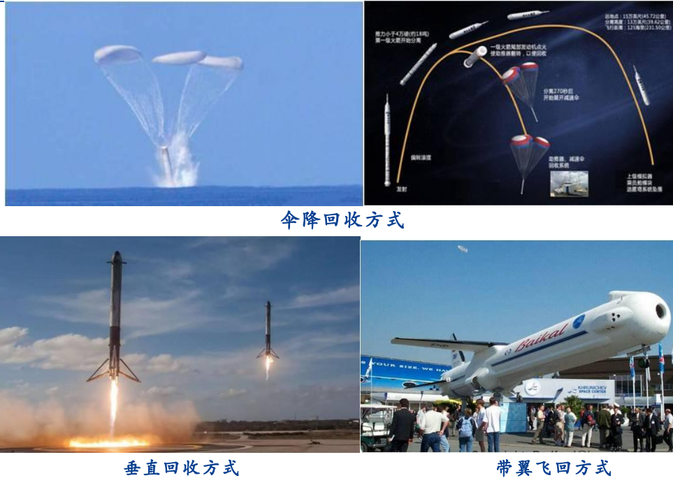
图 11：目前火箭回收主流的方式有三种，分别为伞降回收、垂直返回、带翼飞回
