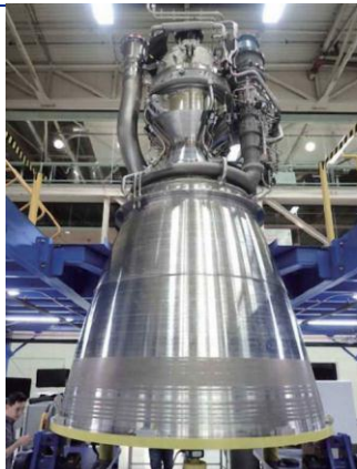
图 7: 蓝色起源公司的 BE-4 液氧甲烷发动机
