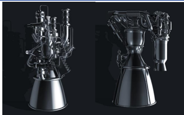
图 13: 蓝箭航天发动机: 凤凰 10 吨级、天鹊 80 吨
