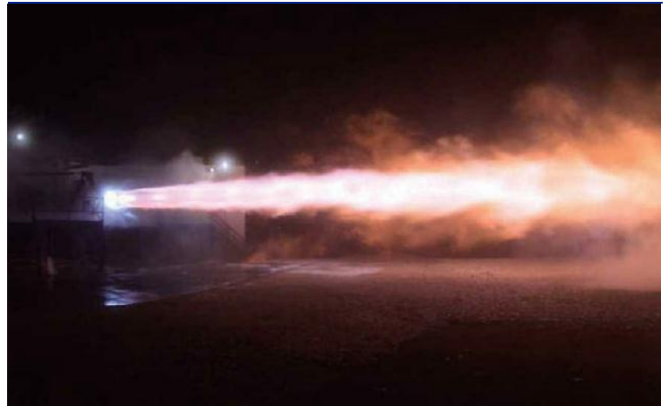
图 6: “猛禽”发动机点火试车
