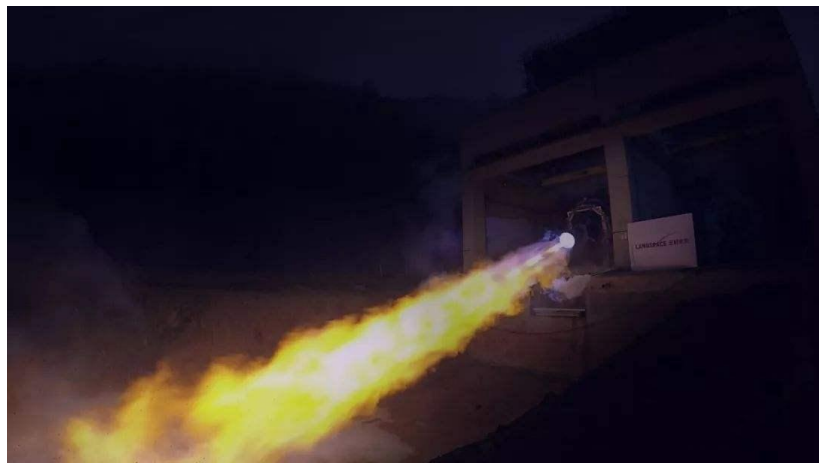
图 10：“天鹊”80 吨液氧甲烷发动机 20s 全系统试车
