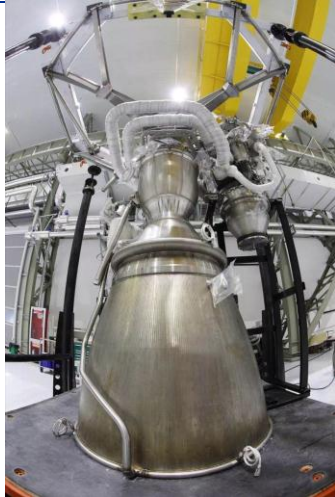
图 9：蓝箭航天“天鹊”80 吨液氧甲烷发动机
