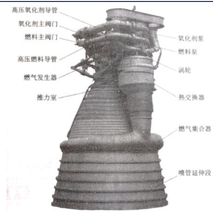
图 4：液体燃料火箭发动机组成示意图
