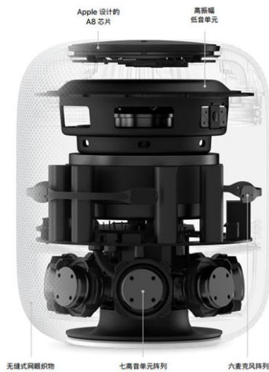
图3: 苹果 HomePod 内部构造
