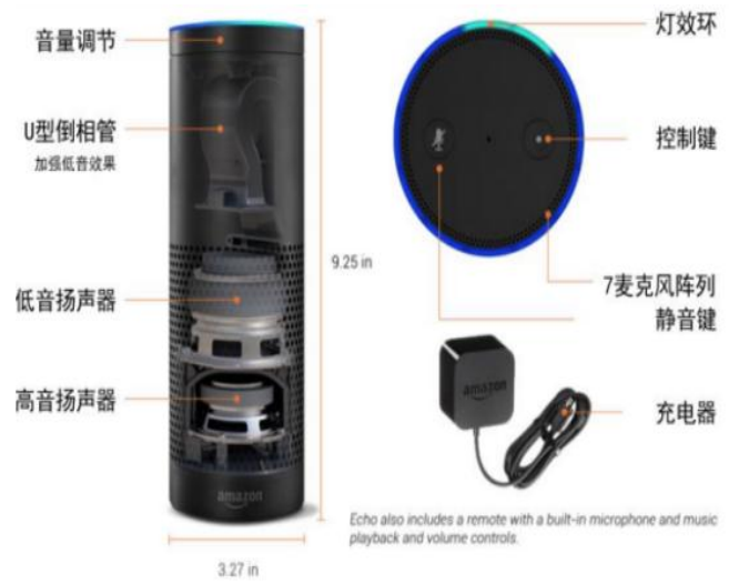
图4: 亚马逊 Echo 内部构造
