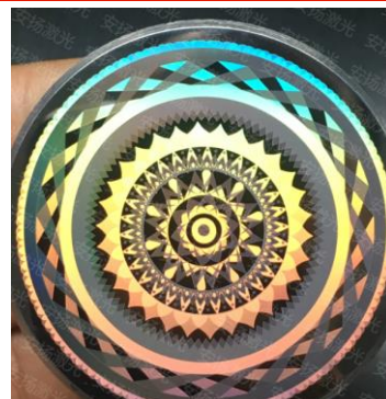
图表57: 飞秒光纤激光器应用于金属炫彩
