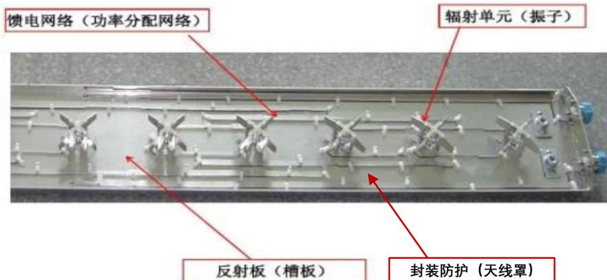
图16 5G天线拆解示意图（无源部分）
