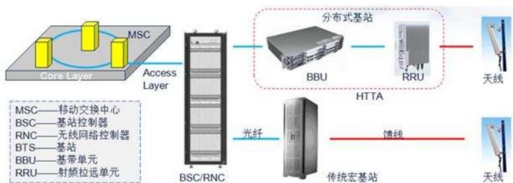
图表22 分布式基站与传统宏基站结构图
