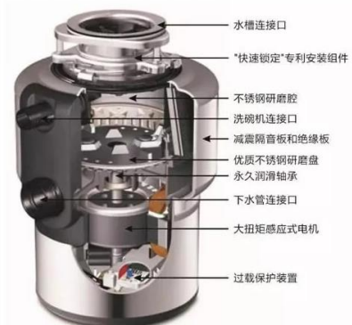
图 4：连接型厨余垃圾处理器的内部结构示意图
