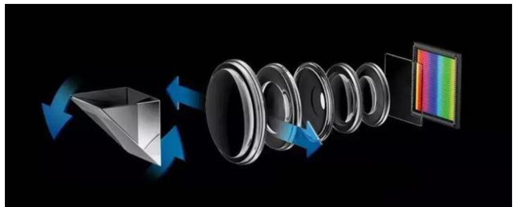
图表 19: 潜望式镜头原理
