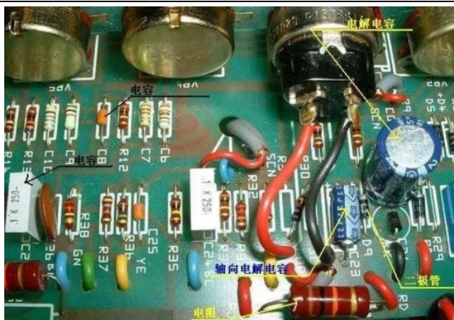
图表 1：线路板上的部分元器件标识
