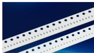
压孔纸带 适用元件尺寸 (inch) 01005/0201/0402
