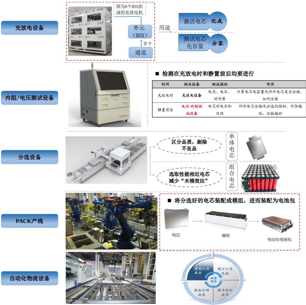
图 13：充放电设备为后处理的核心，测试分选 PACK 设备为必须，具备自动化物流现有优势
