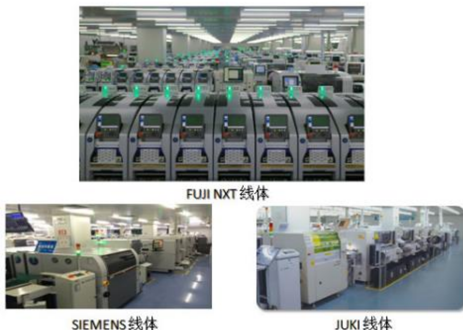
图表16：光弘科技 SMT 产线通过迭代，均为 FUJI、SIEMENS 和 JUKI 等主流品牌新款高速双轨贴片机
