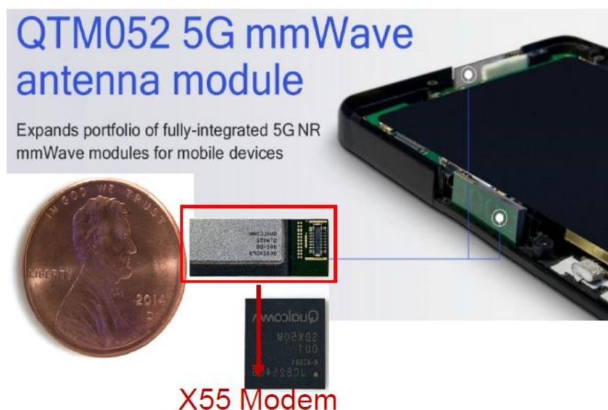
图 22：高通 5G 毫米波天线模组 QTM052
