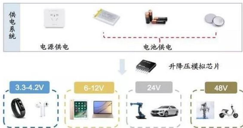
图6 电源管理芯片提供变压、稳压功能
