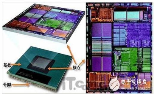
图4 AMD的APU内部结构
