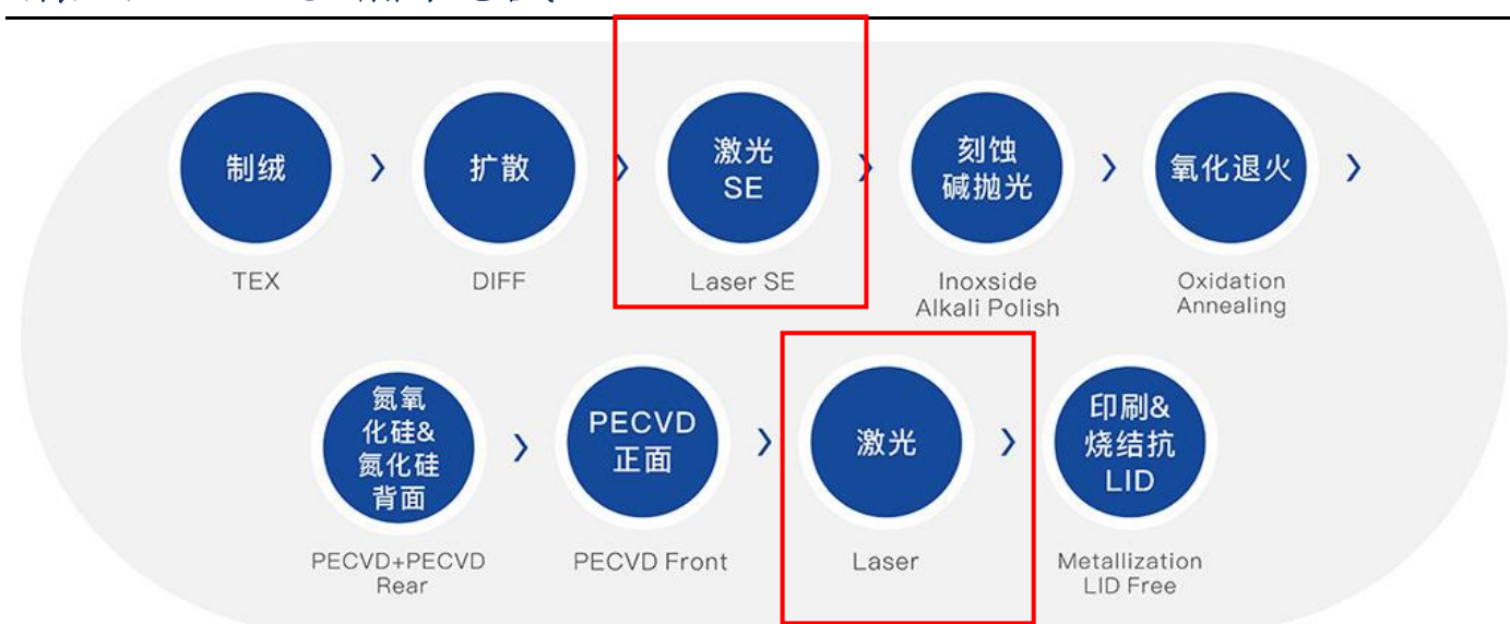
图表 17: PERC+SE 电池制备的工艺路线
