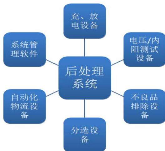
图 33：锂离子电池生产线后处理系统的组成部分
