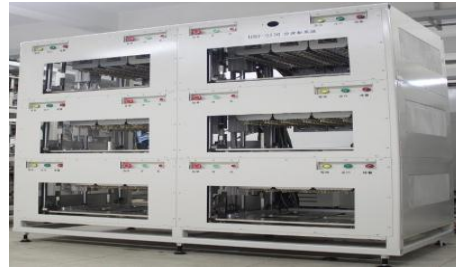
方形电池充放电设备
