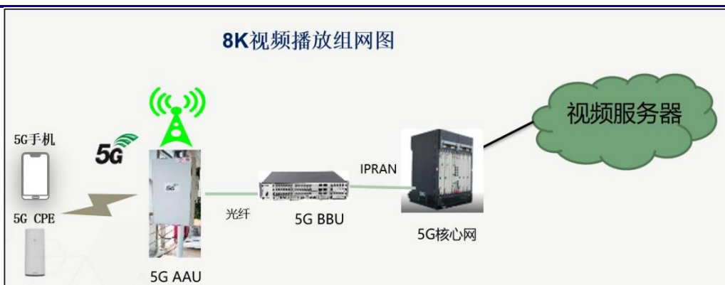
图 34: 基于 5G 网络的 8K 视频播放组网图
