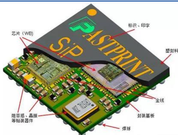
图表 61: 多芯片 SiP 封装结构示意图
