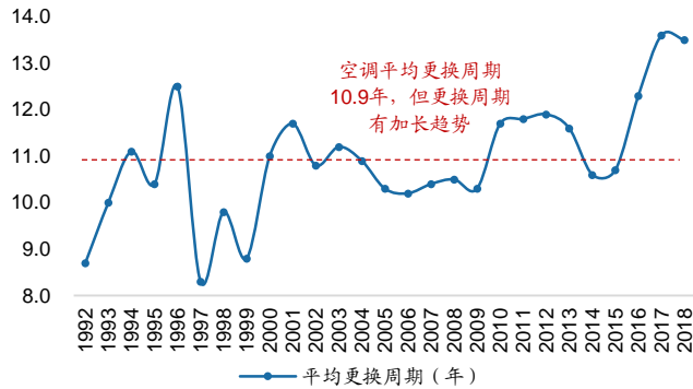
图8: 日本家用空调平均更换周期为10.9年
