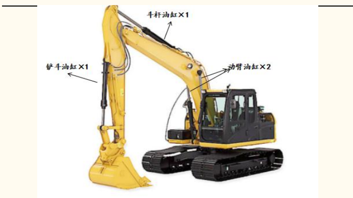
图表 22：挖掘机油缸示意，单台挖机配 4 根油缸
