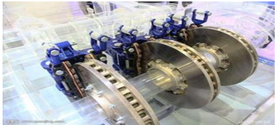
图 21：闸片和制动盘组成一个摩擦副示意图
