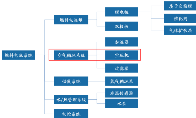
图19: 燃料电池汽车五大系统构成
