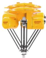
电机安装在固定基座上，可以大大减少机器人运动过程中的惯量。
