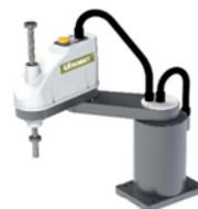
垂直平面具有很好的刚度，在水平面内具有较好柔顺性，动作灵活、速度快、定位精准
