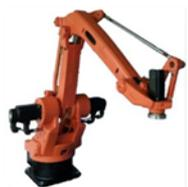
作业范围大、动作灵活、能够抓取靠近机身的物体。缺点是运动直观性差，得到高精度定位精确度难
