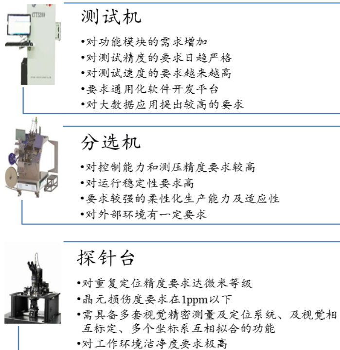
图 2：集成电路测试设备及其技术难点
