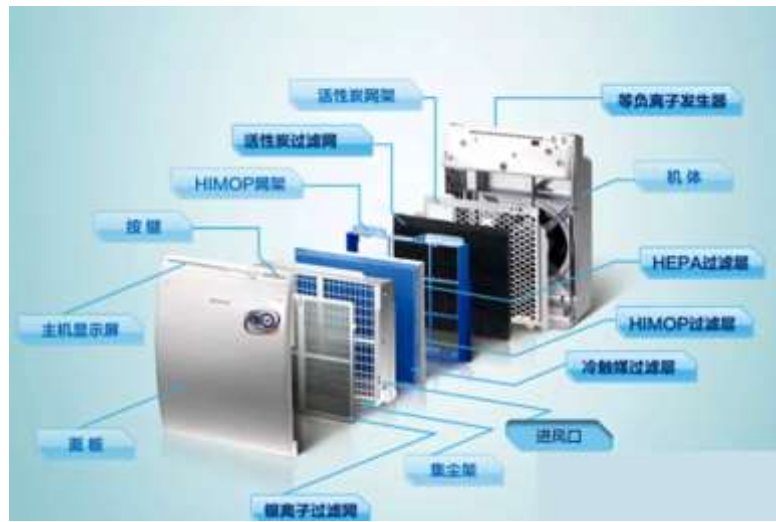
图 25: 一般空气净化器结构示意图
