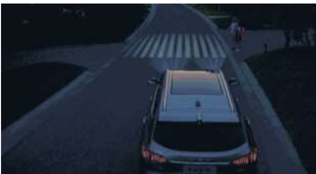
图 2: 2020 款 VV6 搭载智能像素大灯可投影出斑马线
