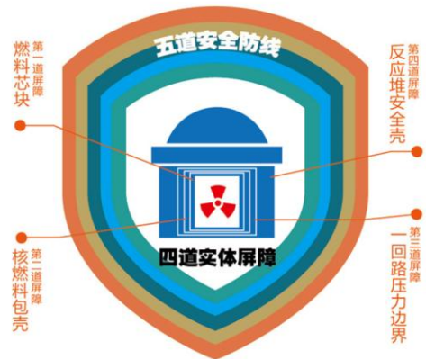
图 16: 核电站五道安全防线
