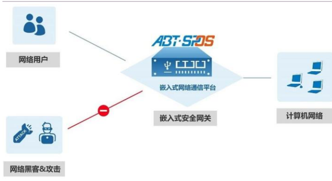
图表4： 嵌入式安全网关在网络中的部署位置
