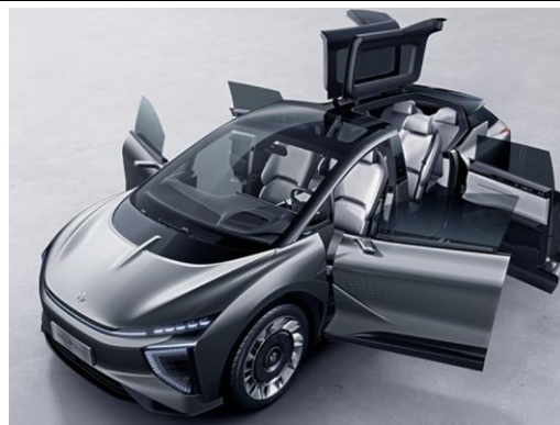
图 7：车门具备对向打开及鸥翼式打开的双重能力
