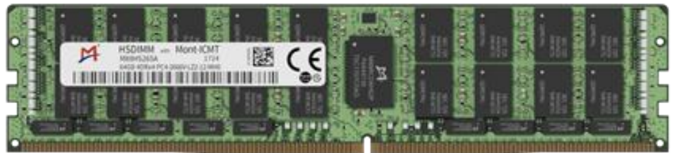
图30： DDR4 内存接口芯片全缓冲“1+9”架构及应用
